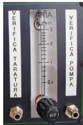
Medidor de caudal
